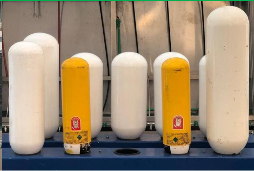
Innentrocknung der Druckbehälter
