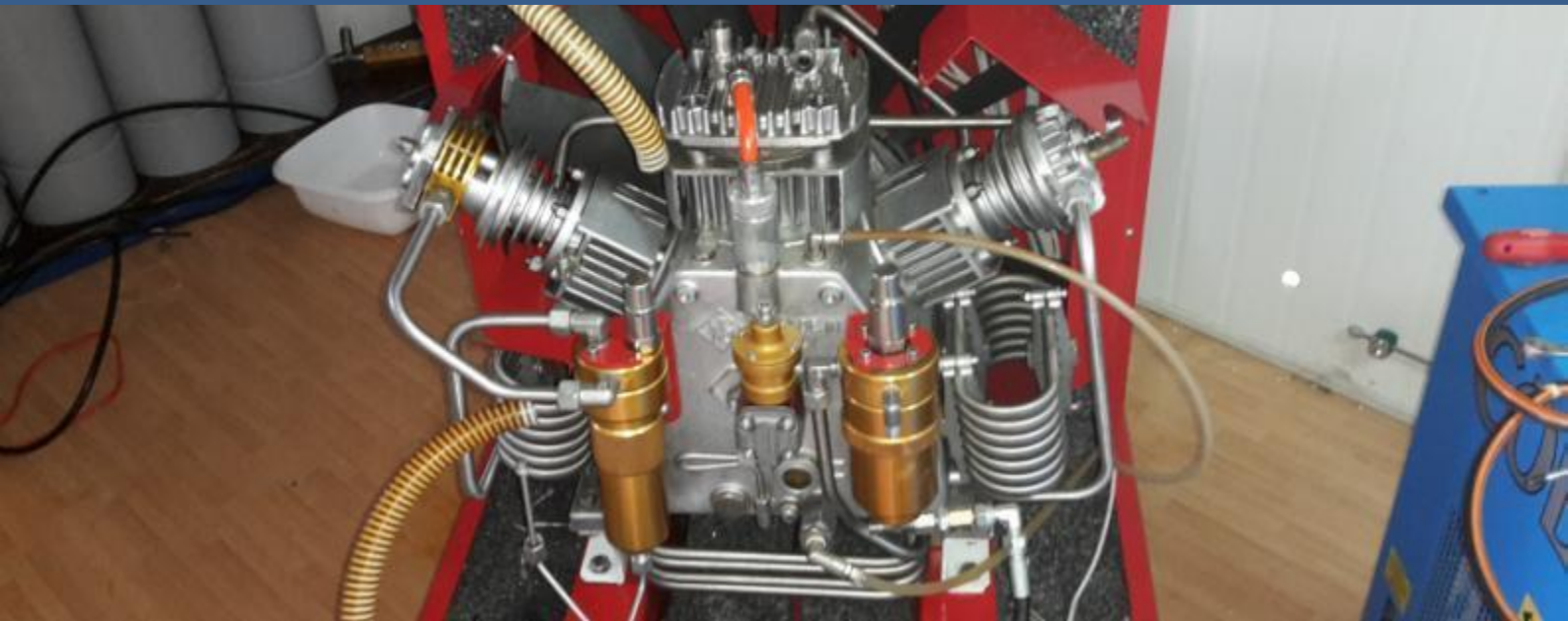
KOMPRESSOR BLOCK VOR DEM SERVICE
